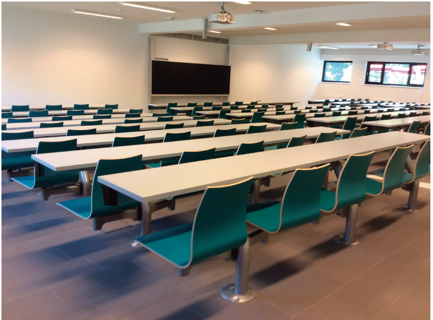
WU – Universität – Wien Sitz in Buchenholz mit Laminat belegt - Sitz drehbar mit automatischer Rückstellung
